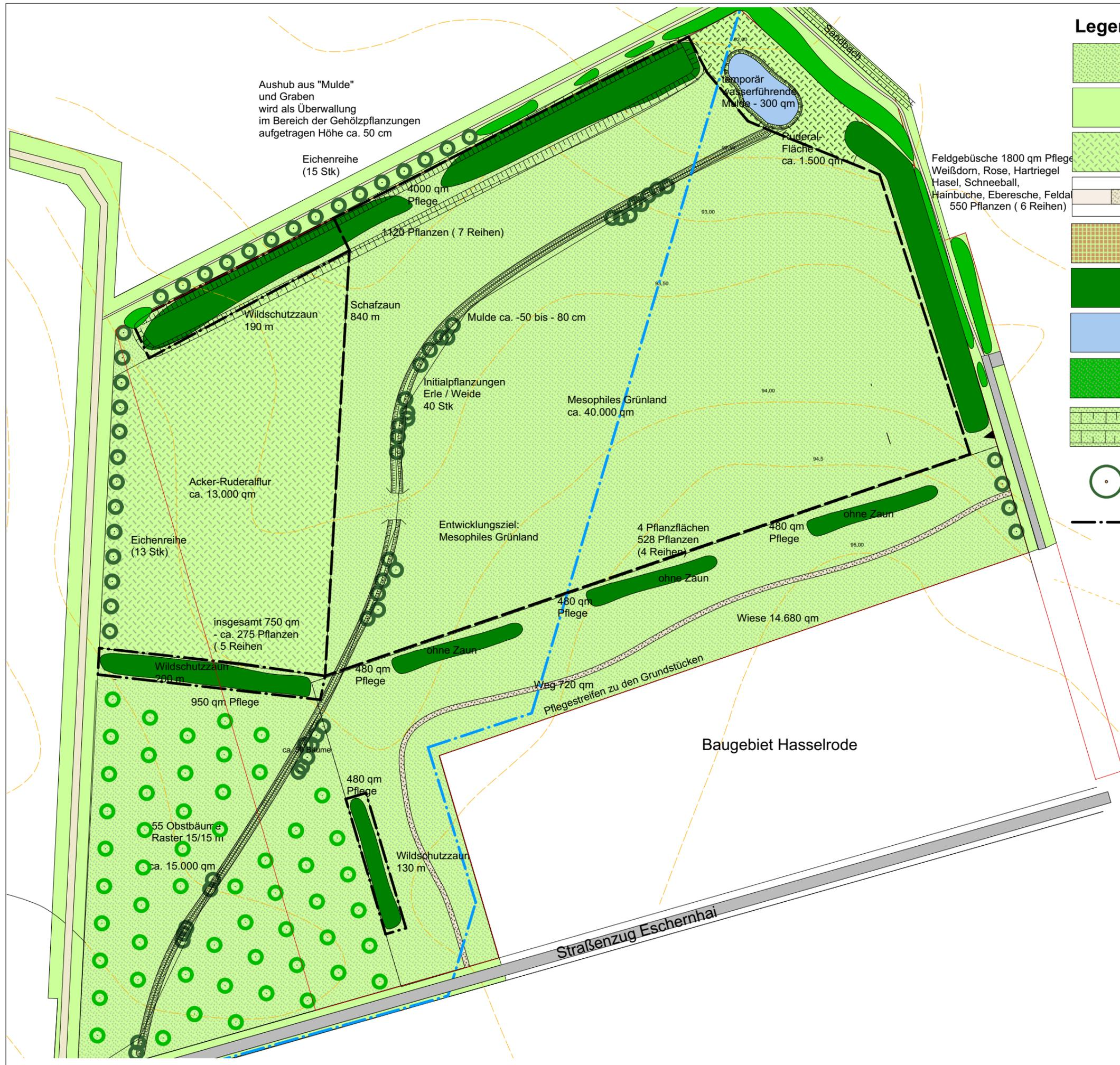
Aushub aus "Mulde" und Graben wird als Überwallung im Bereich der Gehölzpflanzungen aufgetragen Höhe ca. 50 cm
